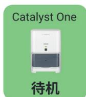
绿色的**待机**图标表示分析仪已与 IDEXX VetLab Station 连接并可通信。
